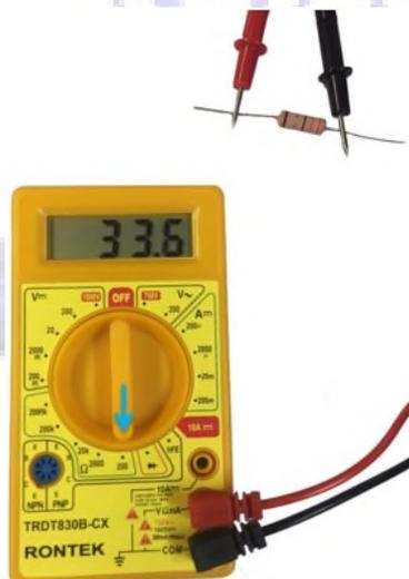
Caso você não saiba o valor da resistência, colocar a chave seletora na escala de maior valor 2000K (2 mega-ohms ). Vá deslocando a chave seletora para escalas de menor valor, até obter a leitura com maior número de dígitos possível antes do ponto decimal.
