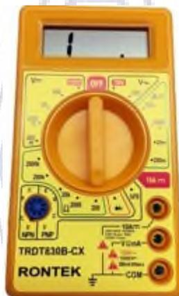
Se o fio não está interrompido, obtém-se valor próximo de zero no display.
