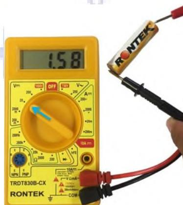
Se você não tem certeza qual é a tensão da pilha, usar a escala de 20V. Se você sabe que a tensão da pilha é 1,5 volts, pode usar a escala de 20V ou de 2000m (2 volts ou 2000 milivolts)
