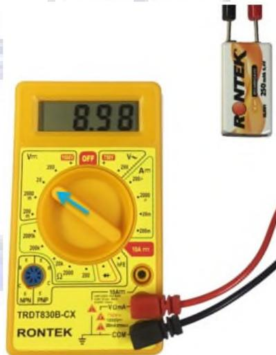
Como medir uma resistência elétrica, por exemplo, 33 ohms?
